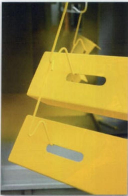
Una particolare cabina a polveri "fuori linea" consente la preparazione di piccole campionature. La verniciatura dei pezzi viene fatta usando pistole elettrostatiche sia manuali che automatiche, del tipo a corona e triboelettriche, con l'impiego dei robot per le grandi tirature.
