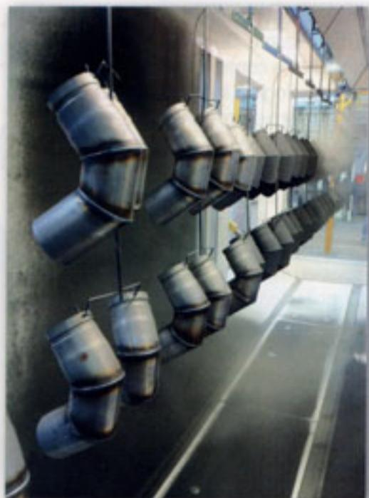
Dopo questi trattamenti di preparazione, i pezzi vengono asciugati a 110° C in un forno esterno al forno di polimerizzazione, in modo da non avere gli inquinamenti o le interferenze che si possono avere quando il forno di asciugatura è interno al forno di cottura, caso tipico di impianti a basso costo o per mancanza di spazio.
