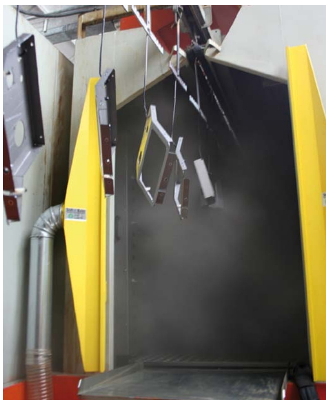
10 - L'area del Soft Rain nebulizzatore occupa solo 60 cm di spazio finale del tunnel esistente: la nebbia nanotecnologica converte le superfici metalliche dei pezzi. La zone du pulvérisateur Soft Rain occupe un espace du tunnel existant de seulement 60 cm : le brouillard nanotechnologique convertit les surfaces métalliques des pièces.
